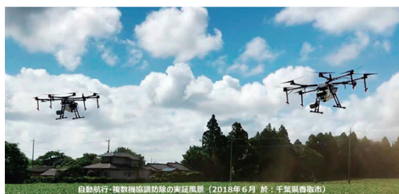
図 6.6 自動航行複数ドローンによる協調作業例 (参考文献 6.24 より引用)
