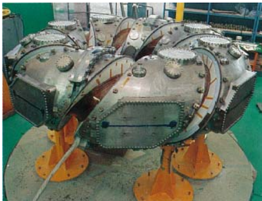
写真 5. CHS の真空容器 (日立製作所提供)
