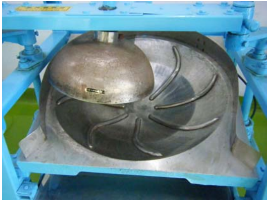
【図2】下が揉捻盤、上が揉み手となる椀
