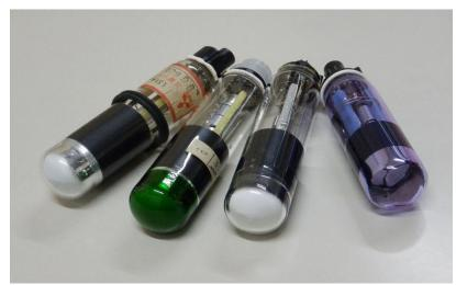
左より、防水パッキン付、ガラス容器着色対応例(緑)、実証実験用、三色一体型の各CRT光源管試作品
