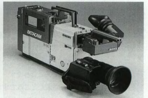
図20: 放送局用1/2インチ・カメラ一体型ビデオテープレコーダー
