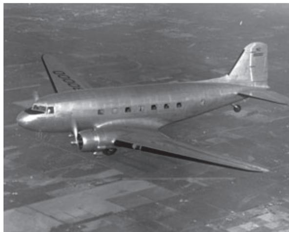
図 4.18 アルコアの Alclad 24S-T3 を胴体のスキンに用いた DC-3<sup>62)</sup>
