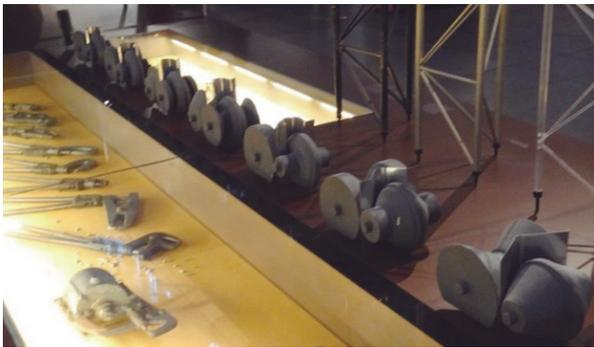
図 4.6 ツェッペリン博物館（フリードリヒスハーフェン）に展示されているツェッペリン飛行船の骨格の一部（上左）とそのロール成形工程（上右）とそのロールおよびリベット接合の治工具（下）（著者撮影）
