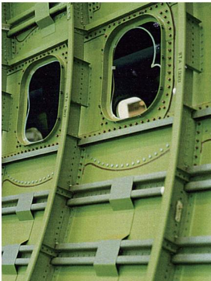
図 10.15 テーパーロール加工したストリンガーを用いたボーイング 767 の胴体<sup>31), 32)</sup>
