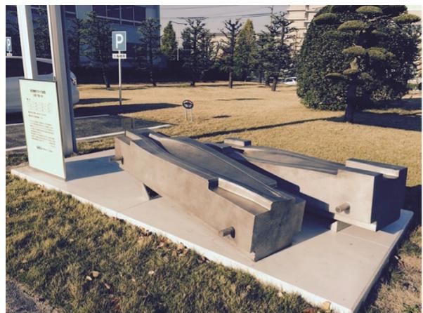
図 5.16 UACJ に保管されている航空機用プロペラの鍛造金型
