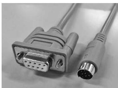
図 6.31 DTM 音源に搭載されたシリアルポートと接続用シリアルケーブル
