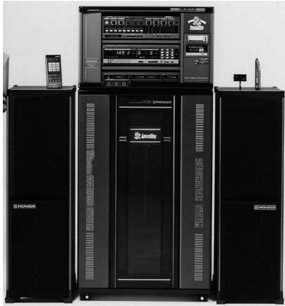
図 8.5 パイオニア社レーザーカラオケのオートチェンジャー・システム（中央下部にレーザーディスクを収納）
