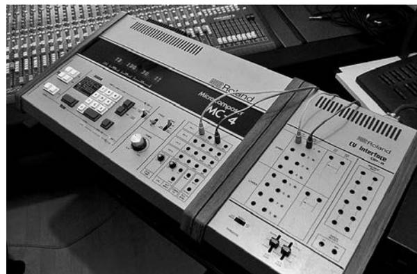
図 2.18 ローランド OP-8 および OP-8 と MC-4 の接続例
