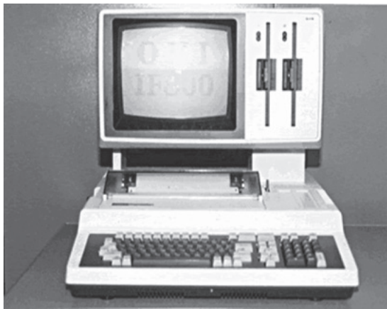
図 3.12 沖電気パーソナルコンピュータ if800 モデル 30 (プリンタ内蔵)
