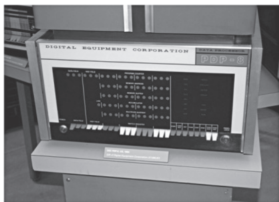
図 2.2 ミニコンピュータ DEC PDP-8 : 1965 年に最初 に出荷されたモデル (Computer History Museum で撮影)
