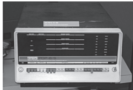
図 2.6 DEC PDP-8/s ミニコンピュータ (1965 年に出荷された低価格モデル) (Computer History Museum で撮影)
