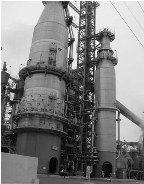
図6.5-2 最新の連続蒸解釜
