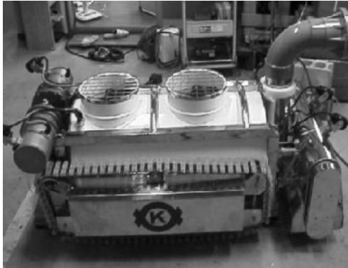
写真5.17 「取水路除貝ロボット」
