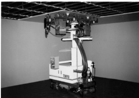
写真5.5 「内装工事ロボット」
