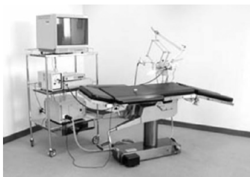
写真6.5 内視鏡下手術支援ロボットMTLP-1
