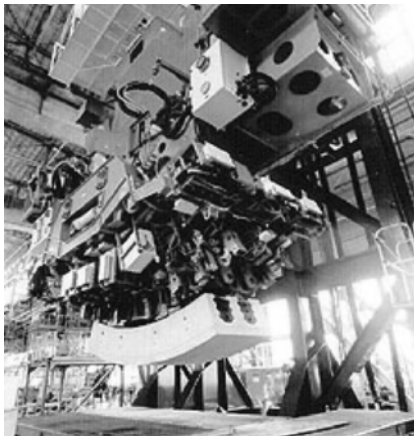
写真5.10 「セグメント自動組み立てロボット」
