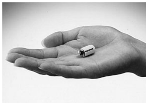
写真6.6 無線伝送の内視鏡カプセル
