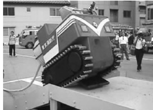
写真5.30 「消火ロボット」
